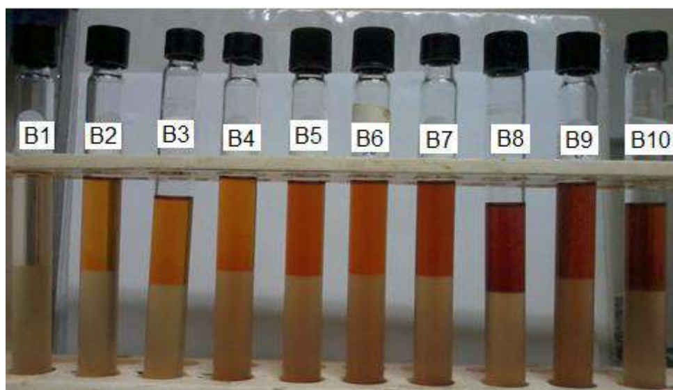
Figura 16. Resultado do teste colorimétrico do ácido hidroxâmico realizado nas amostras B1 a B10 preparadas com diesel amarelo (S50).
