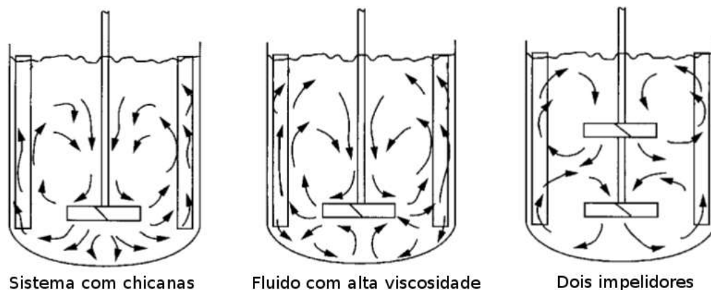
Figura 2.14: Esquema de padrões de escoamento com turbina de pás inclinadas. Fonte: traduzido de [15]
