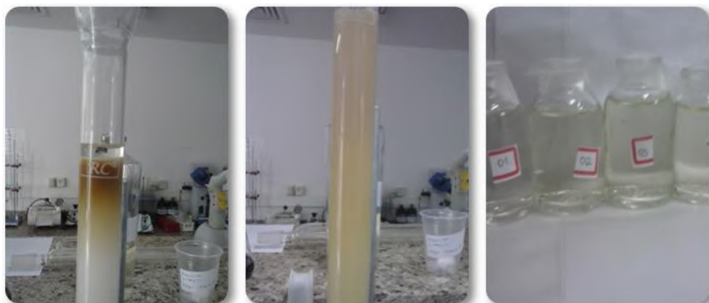
Figura 9: Imagem a esquerda mostrando a aplicação da amostra; imagem central mostrando eluição da amostra pela coluna; imagem a direita mostrando as frações coletadas.
