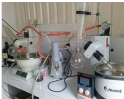
Figura 7: Evaporador rotatório de pressão reduzida
