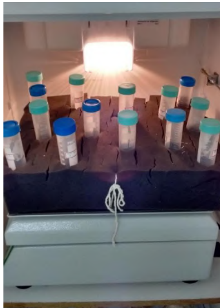
Figura 14: Tubos Falcon contendo meio pré-fermentativo com os fungos HB18a e HB19a dentro do shaker a 30 °C e agitação constante de 120 rpm.
