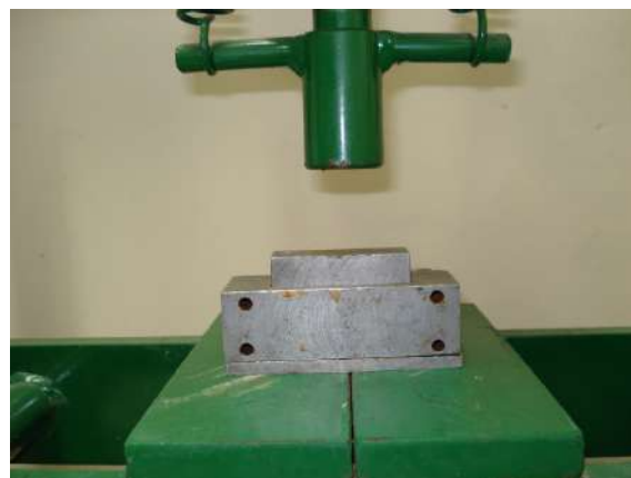
Figura 14 - Prensa utilizada na conformação dos corpos de prova
