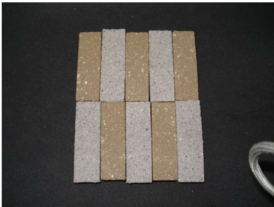
Figura 28 – Corpos de prova produzidos com Porcelanato Esmaltado (amarelados) e Porcelanato Polido (cinzas) após a etapa de queima.
