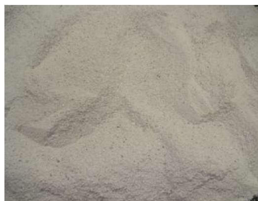
Figura 22 - Porcelanato Polido após a etapa de pulverização
