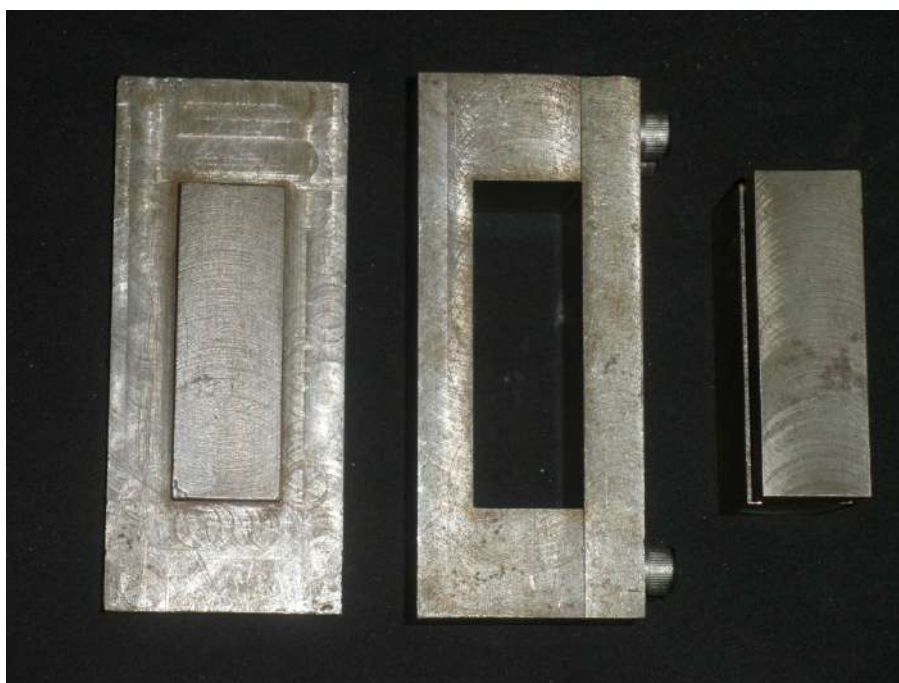
Figura 12 – Matriz retangular de aço inox utilizada na compactação dos corpos de prova.
