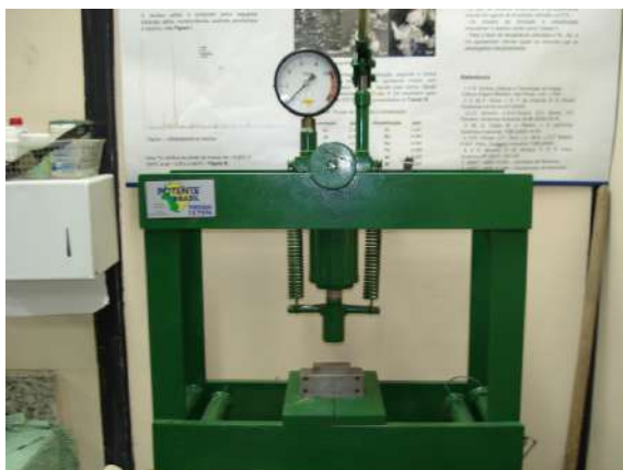
Figura 13 - Prensa utilizada na conformação dos corpos de prova
