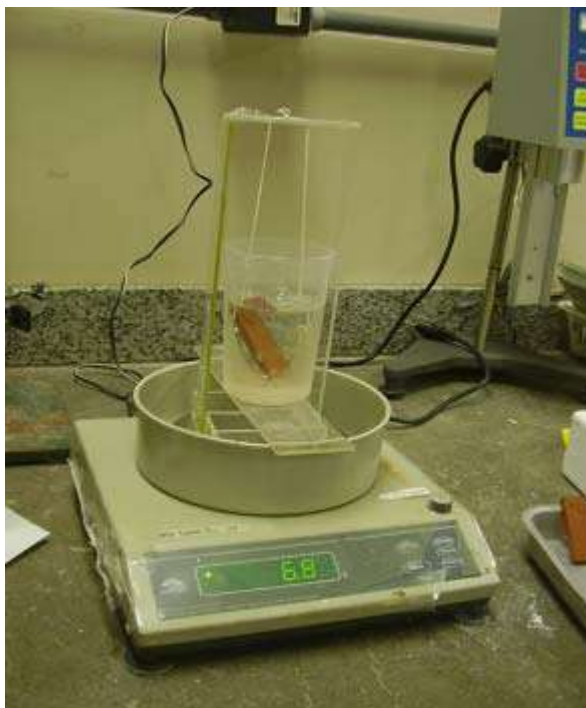
Figura 16– Aparelho do Princípio de Arquimedes utilizado no estudo
