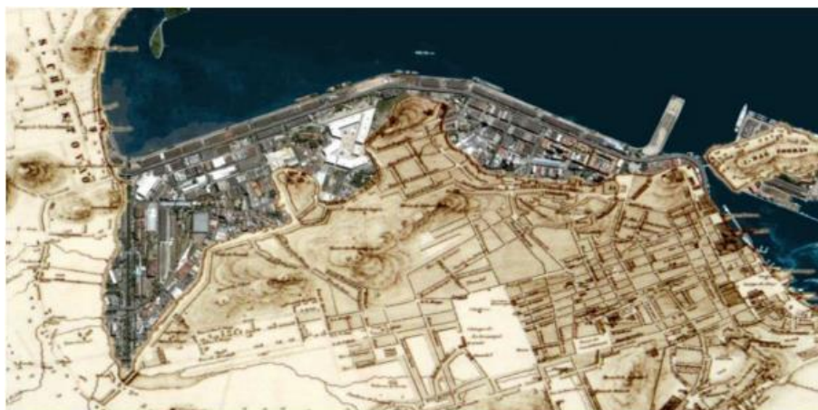
Figura 1: Comparativo entre a área original do porto em relação à área após a aterragem
