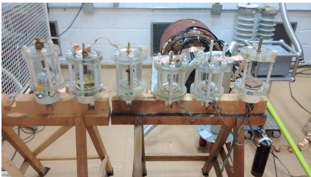
Figura 8.1: Todas as células de carga conectadas em paralelo.
