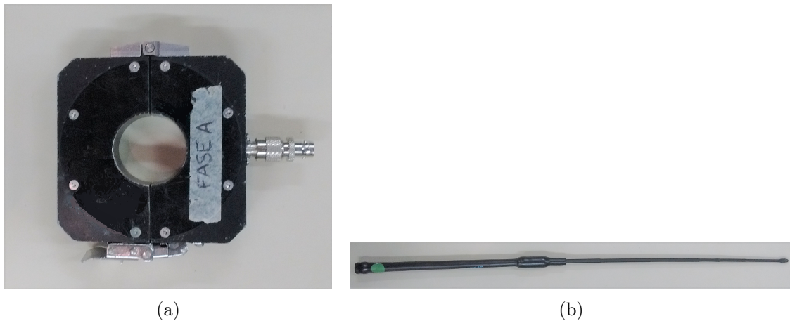
Figura 8.3: Sensores utilizados: (a) HFCT; (b) Antena Monopolo.
