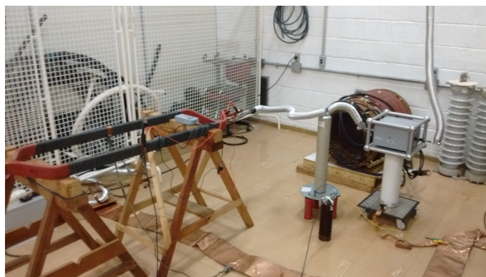
Figura 8.23: Barra estatórica ensaiada em laboratório.
