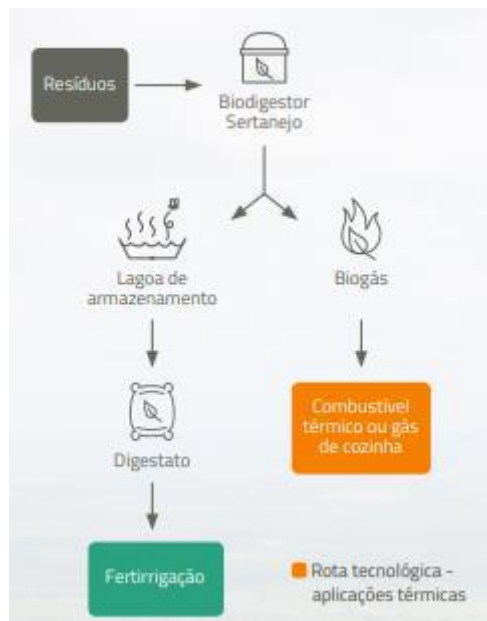
Figura 5: Rota tecnológica do Biodigestor Sertanejo
