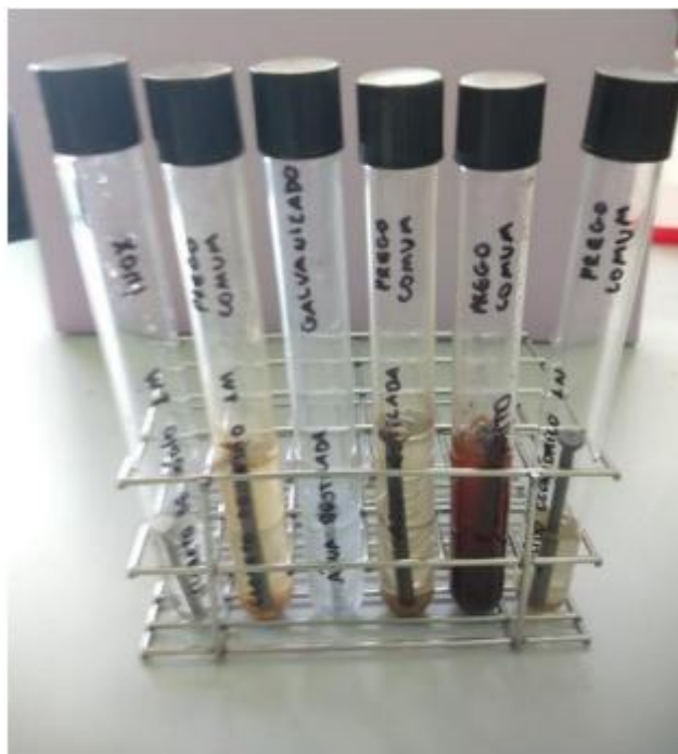
Figura 2 – Imagem do Experimento durante o processo de Corrosão dos Pregos. Fonte: Os autores.
