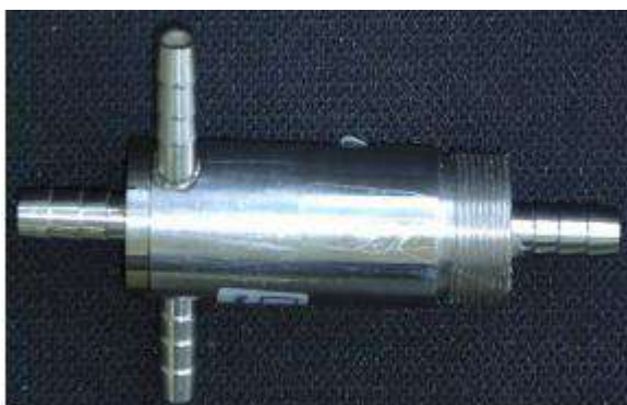
Figura 3 – Hidrociclone projetado especificamente para retenção celular.
