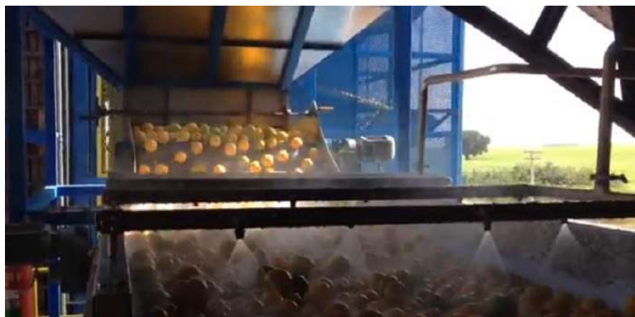
Figura 12: Lavadora industrial de laranjas (vista interna)
