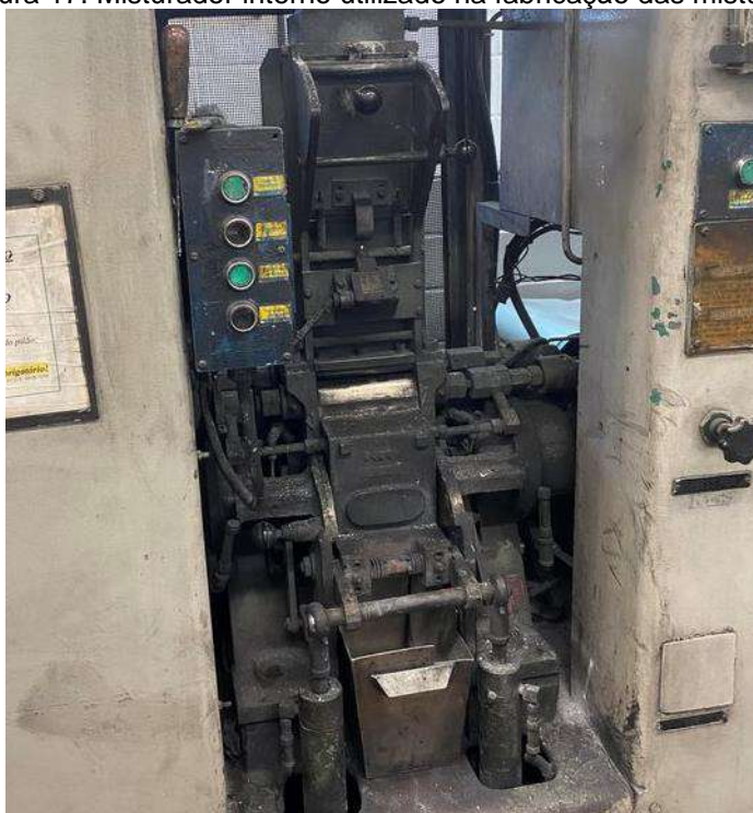
Figura 17. Misturador interno utilizado na fabricação das misturas.
