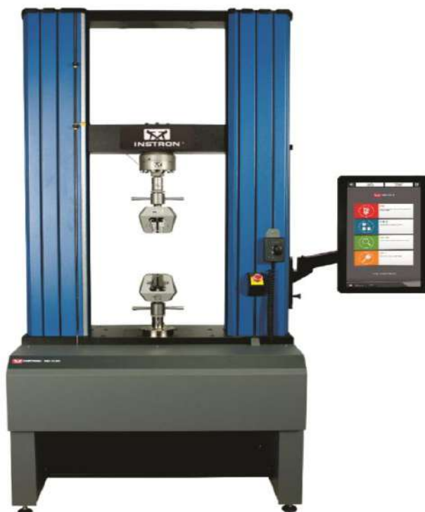
Figura 26. Equipamento Instron similar ao utilizado para fazer os ensaios de deformação.
