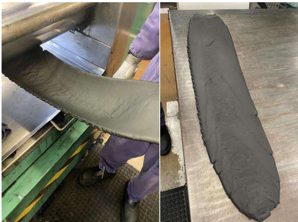
Figura 20. Mistura sendo evacuada do ME (esquerda) e a napa formada (direita).
