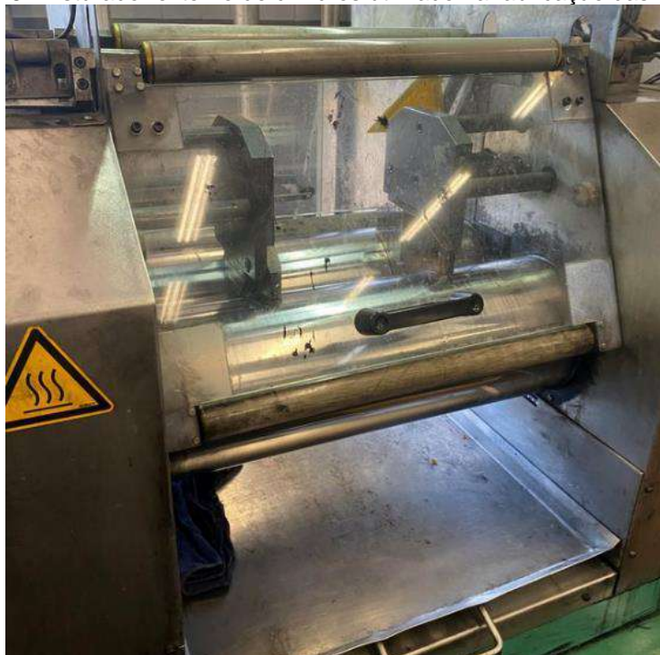
Figura 18. Misturador externo de cilindros utilizado na fabricação das misturas.
