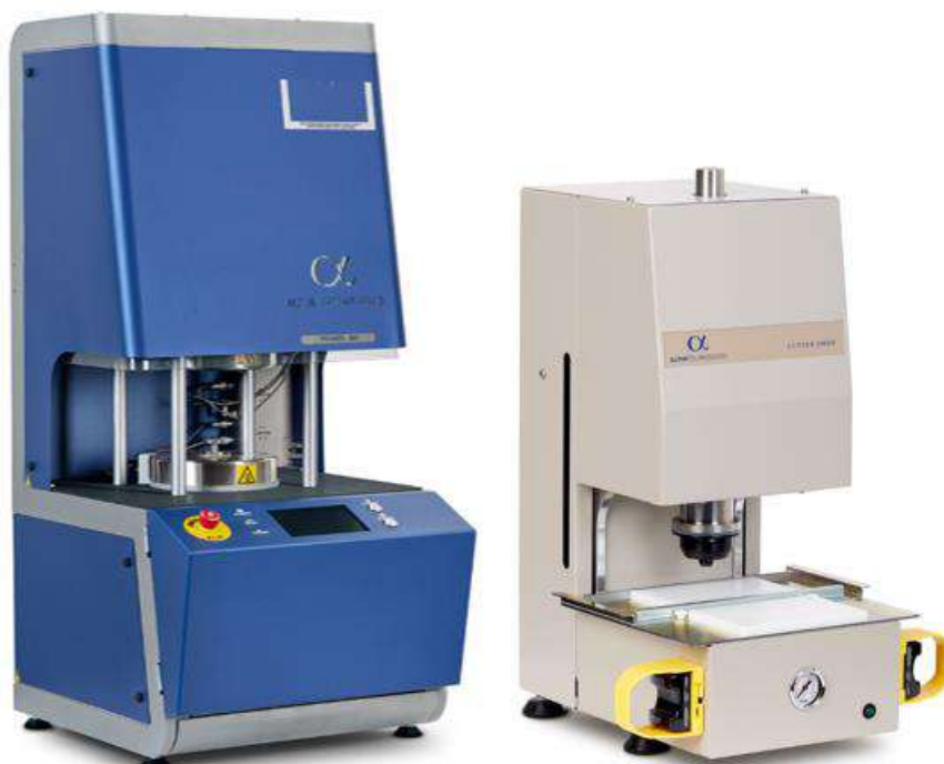
Figura 22. Viscosímetro de Mooney (esquerda) e Cortadeira de amostras (direita)
