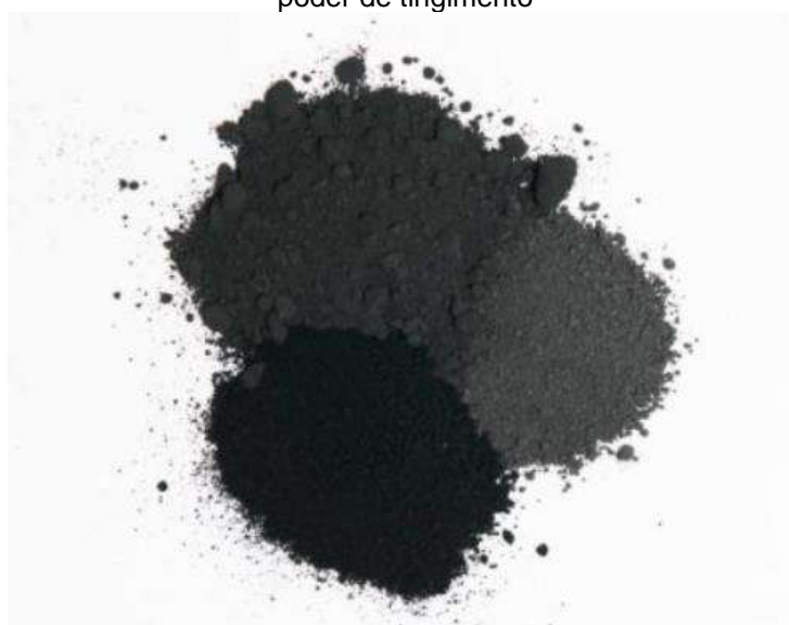
Figura 9. Três grades de negro de carbono, com tamanhos de partículas diferentes e seu poder de tingimento
