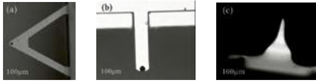
Figura 8.3 – Algumas hastes usadas em AFM como observadas por microscopia óptica. Os pontos pretos na extremidade da haste são as pontas de prova: (a) haste triangular com k=0,35 N/m, f=40 kHz e ponta de base quadrada; (b) haste retangular com k=5 N/m, f=160 kHz e ponta de base piramidal; (c) visão lateral da ponta de prova de base piramidal mostrada em (b): o diâmetro é menor que 5 nm no ápice.
