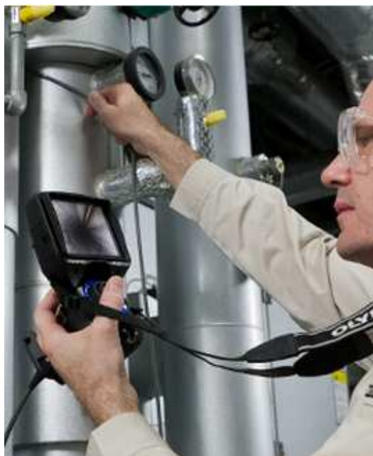
Figura V-1 – Utilização de endoscópio para inspeção de equipamento
