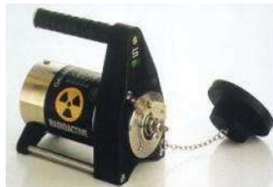
Figura V-7 – Irradiador gama específico para fontes de selênio-75
