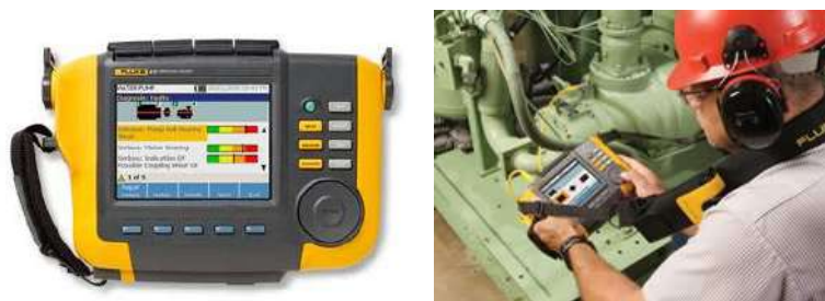
Figura V-5 – Equipamento de análise de vibração
