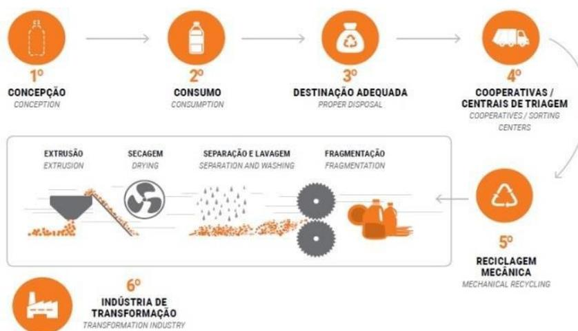
Figura 7: Fluxograma das etapas da reciclagem mecânica.
