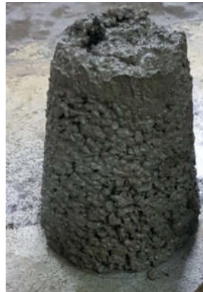
Figura 19 - Matriz dosada pelo método ACI no estado fresco com baixa trabalhabilidade e alta porosidade
