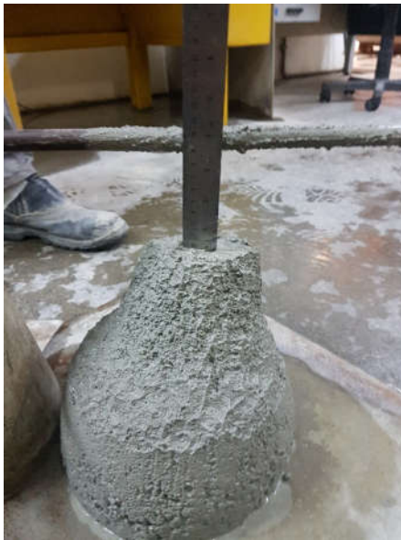
Figura 20 - Abatimento de tronco de cone da nova dosagem utilizando água REF
