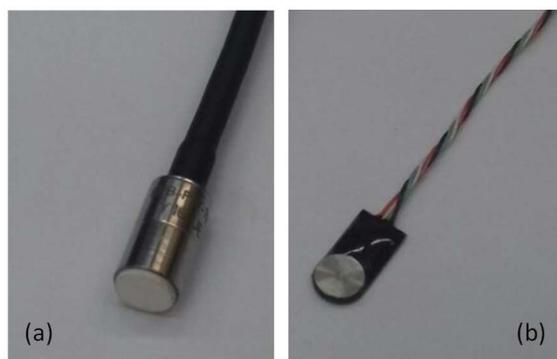
Figura 4.6 – Transdutores. (a) transdutores de poro pressão, (b) transdutor de tensão total
