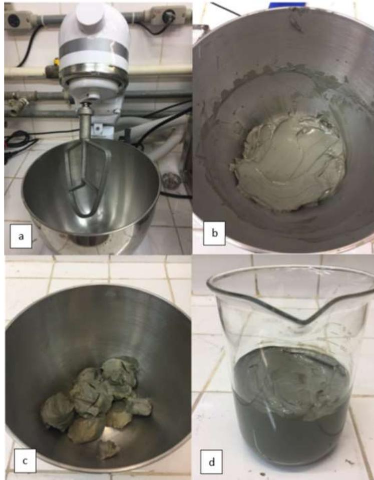
Figura 3.24 – (a) misturador tipo planetário; (b) mistura preparada; (c) grumos de argila marinha; (d) argila marinha preparada para o ensaio de palheta
