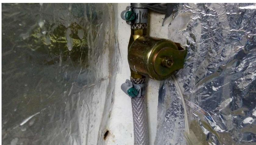
*Figura 4.13 – Solenoide utilizado para a liberação da água da caixa de lastro e esvaziamento da caixa de ensaios*
