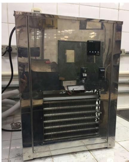
Figura 3.20 – Módulo de controle e manutenção da temperatura
