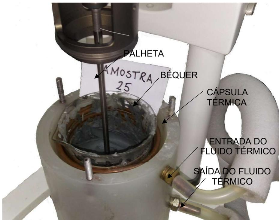
Figura 3.22 – Montagem do ensaio com geometria de palhetas
