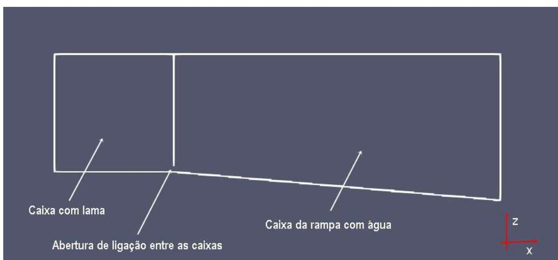
Figura 6.4 – Contornos das caixas de água e de lama do modelo numérico
