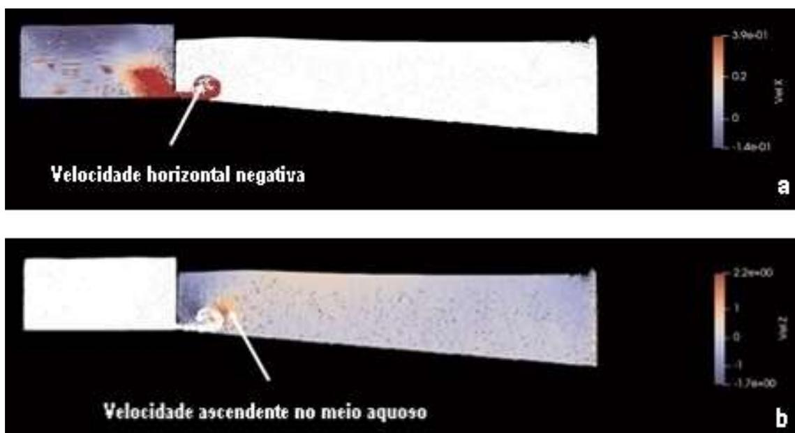
Figura 6.12 – Modelagem numérica para simular o comportamento do material no ensaio centrífugo w90\_0.9. Tempo transcorrido no modelo numérico,  $t = 0,05$ s (a) Velocidade horizontal da lama, (b) velocidade vertical da fase aquosa
