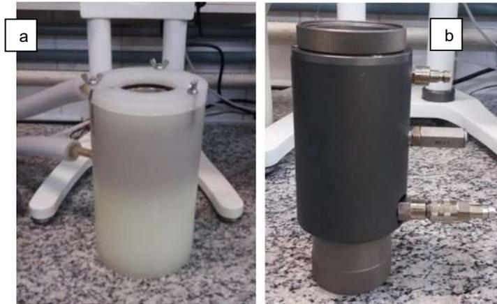
Figura 3.21 – Recipientes para controle de temperatura nos ensaios (a) cápsula térmica (ensaio de palheta); (b) jaqueta térmica (ensaio com os cilindros concêntricos)
