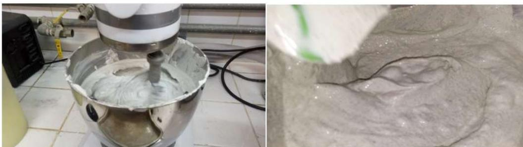
*Figura 4.12 – Preparação da amostra com speswhite e carvão*
