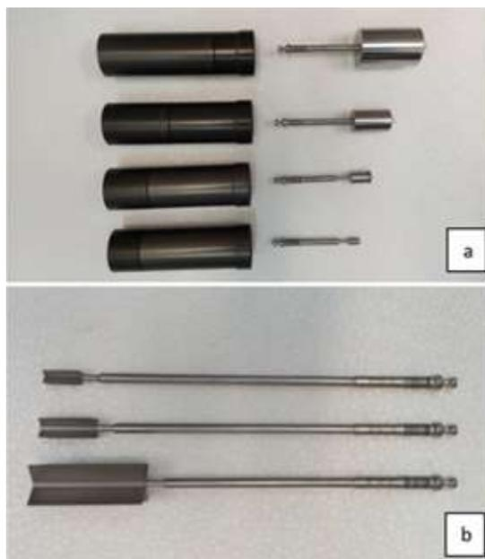
Figura 3.19- Geometrias disponíveis no LM2C: (a) de cilindros concêntricos (de cima para baixo) CCT-40, CCT-25, CCT-14, CCT-8; (b) de palheta (de cima para baixo) VT 20-10, VT 30-15, VT 60-30
