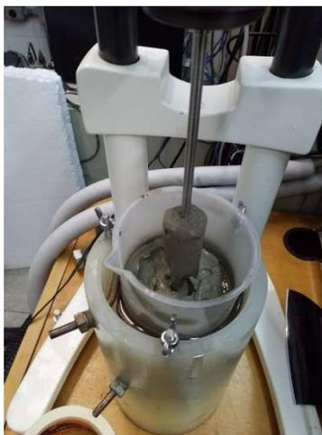
*Figura 3.25- Final do ensaio de cisalhamento com geometria de palheta*
