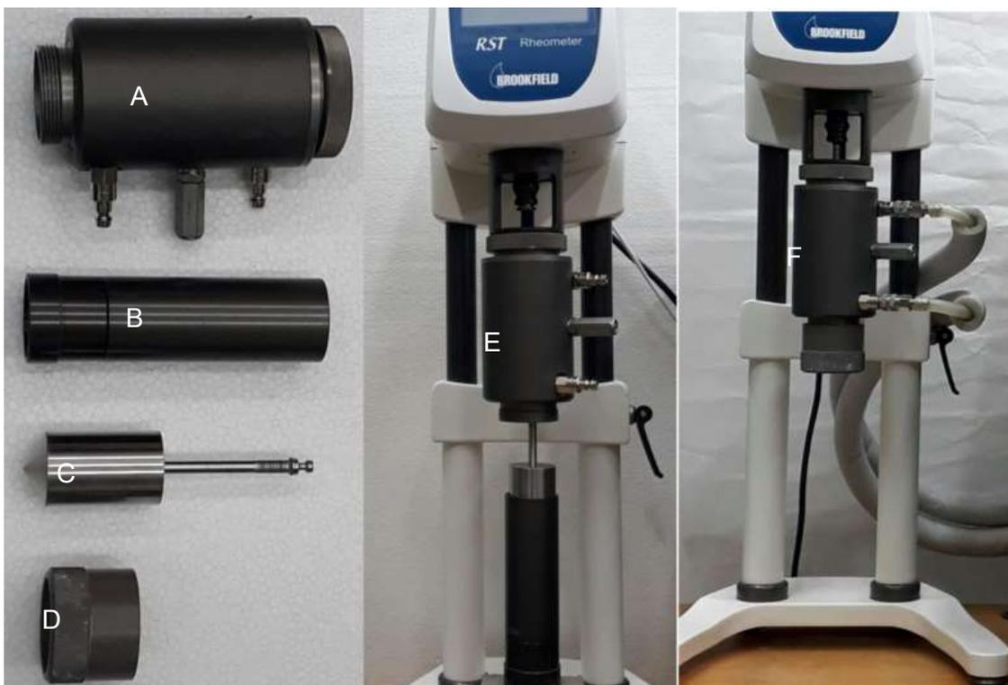
Figura 3.23 – Montagem do ensaio com cilindros concêntricos. (A) jaqueta térmica, (B) cilindro externo, (C) cilindro interno, (D) tampa da jaqueta térmica, (E) posição de encaixe das peças, (F) equipamento preparado com as mangueiras de entrada e saída do fluido térmico encaixadas
