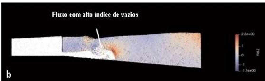
Figura 6.18 – Modelagem numérica para simular o comportamento do material no ensaio centrífugo w100\_0.9. Tempo transcorrido no modelo numérico,  $t = 0,15$  s (a) Velocidade horizontal da lama, (b) velocidade vertical da fase aquosa
