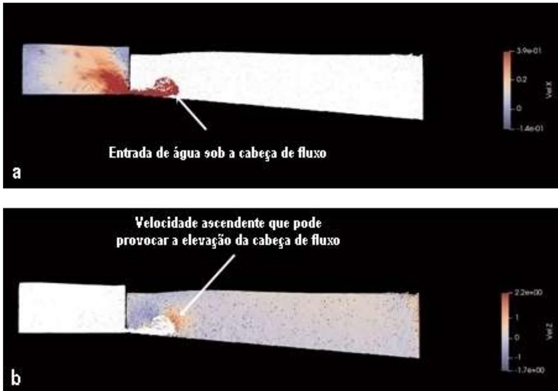
Figura 6.13 – Modelagem numérica para simular o comportamento do material no ensaio centrífugo w90\_0.9. Tempo transcorrido no modelo numérico,  $t = 0,08$  s (a) Velocidade horizontal da lama, (b) velocidade vertical da fase aquosa
