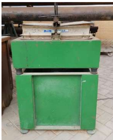
Figura 3.2- Peneirador mecânico com peneira de malha de 1,18 mm
