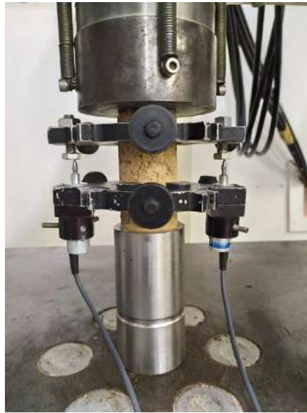
Figura 3.11- Ensaio de compressão uniaxial do bio-concreto de madeira
