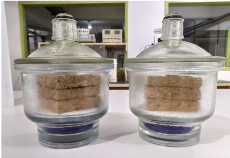
Figura 3.15- Uso de dessecadores para evitar ganho de umidade no bio-concreto
