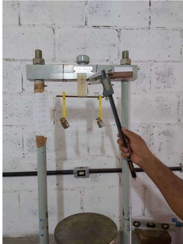
Figura 3-28 – Realização do Ensaio de Extensão da Membrana de Látex
