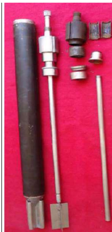
Figura 3-8 – Ensaio de Palheta: (a) Vista geral do Ensaio SP16; (b) Detalhe da Palheta COPPE/UFRJ/GROM utilizada no ensaio (Souza, 2014).
