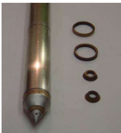
Figura 3-10 – Detalhes do piezocone COPPE/UFRJ utilizado. Empresa SIGEO.
