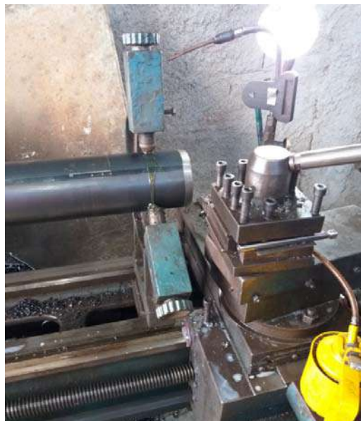
Figura 3-13 – Execução do bisel no torno mecânico no tubo de latão. Mesmo procedimento usado no tubo de PVC.
