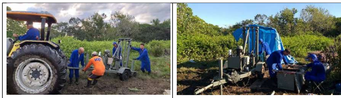
Figura 3-11 – Detalhes da mobilização do equipamento de CPTu.
