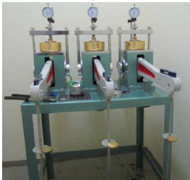
Figura 3-20 – Prensa utilizada no ensaio de adensamento oedométrico
