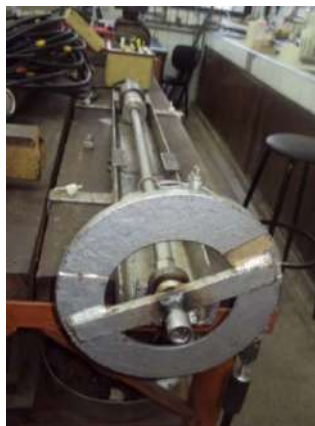
Figura 3-6 – Mesa para Calibração do Sensor de Torque.
