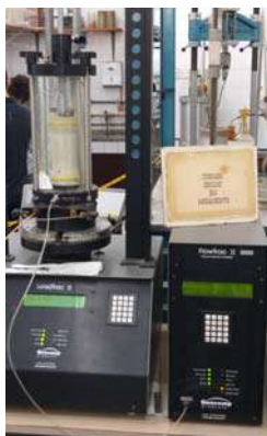
Figura 3-26 – Ensaio Triaxial em Execução
