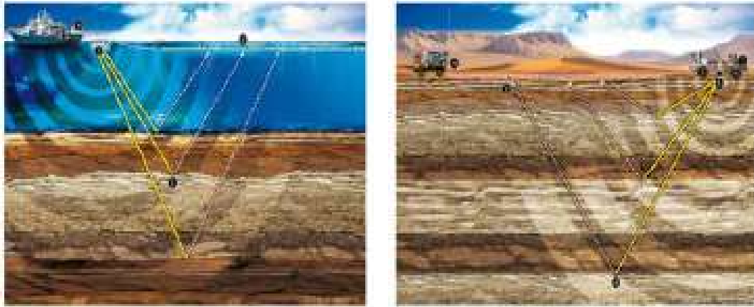
(a) Levantamento sísmico marítimo. 1- Fonte Sísmica, 2- Representação de uma reflexão da estrutura geológica, 3 - Streamer , 4 - Navio Sísmico. (b) Levantamento sísmico terrestre. 1 - Cami- vibrator, 2- Representação de uma reflexão da estrutura geológica, 3 - Streamer , 4 - Navio Sí- smico.
