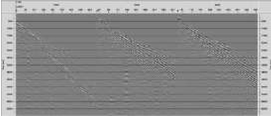
Figura 4.21: Exemplo de tiros dos dados sísmicos pré-empilhamento da bacia do Espírito Santo filtrados com técnica F-K e aplicação do muting na coluna de água
