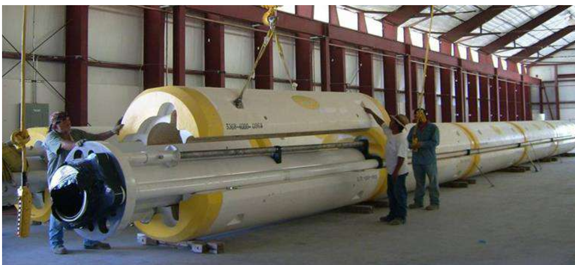
Figura 2.14 – Montagem da junta de riser com flutuadores [2]
