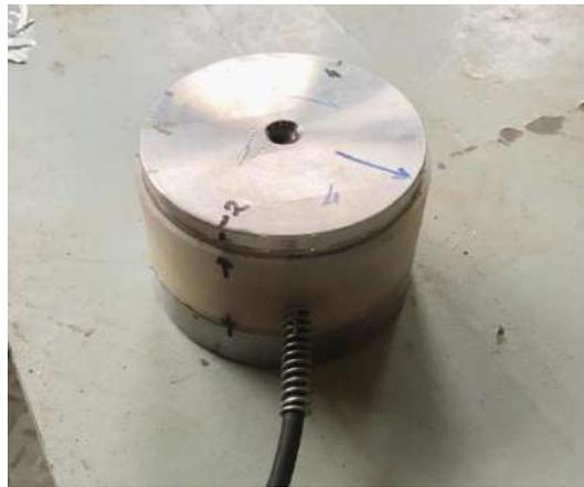
Figura 3.15 – Célula de carga antes de ser instalada sobre o macaco hidráulico da plataforma.
