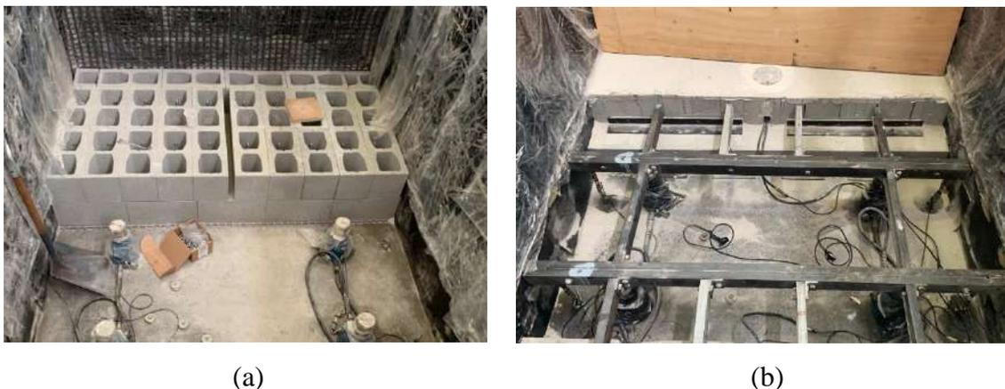
Figura 3.4 – Modificações no modelo físico: (a) construção dos capitéis em bloco de concreto; (b) capitel em bloco de concreto com laje em concreto armado e plataforma hidráulica.
