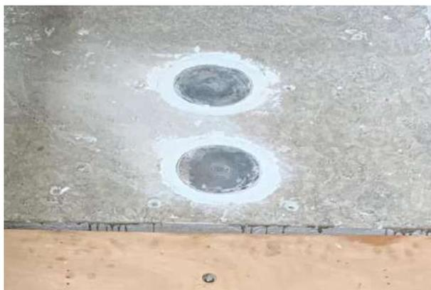
Figura 3.16 – Células de pressão total instaladas no capitel, envoltas com gesso para nivelamento das superfícies.
