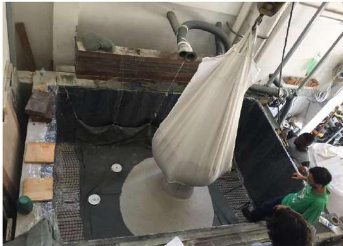
Figura 3.25 – Lançamento da bolsa de areia com auxílio da ponte rolante.
