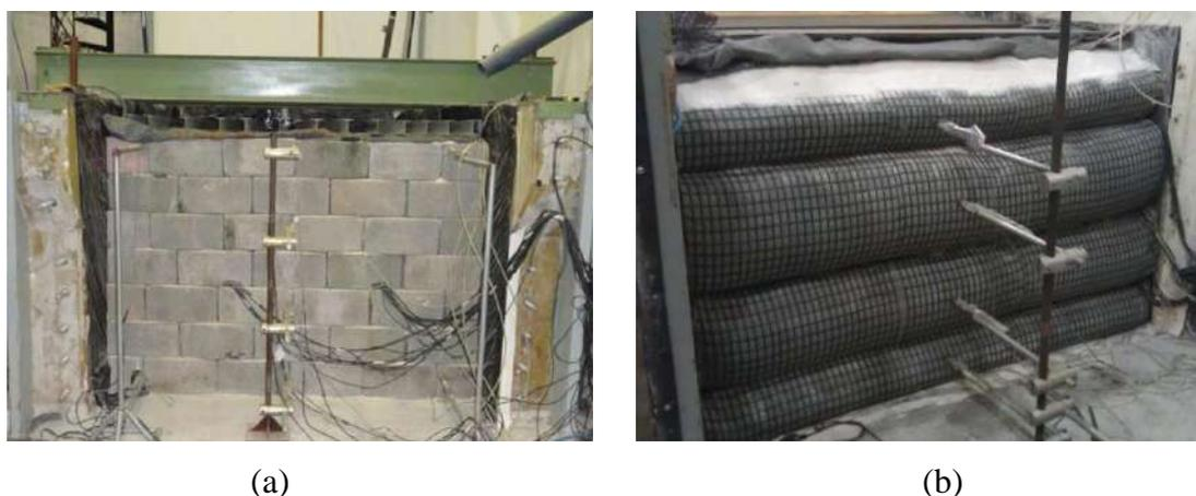
Figura 3.1 – (a) Muro de solo grampeado com face em bloco de concreto (ELEUTÉRIO, 2013);
