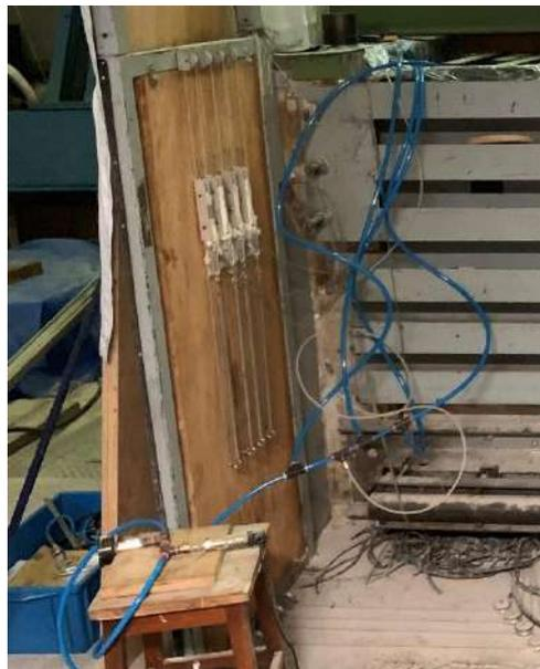
Figura 3.20 – Transdutor de pressão conectado em série na mangueira responsável por aplicar a pressão nas bolsas de ar comprimido.
