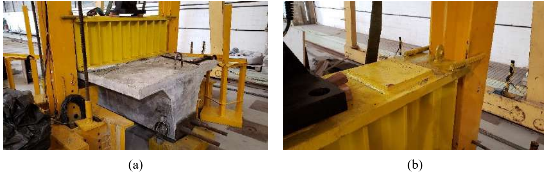
Figura 5.37 – Soldagem de extensão de segurança: (a) vista e (b) detalhe.
