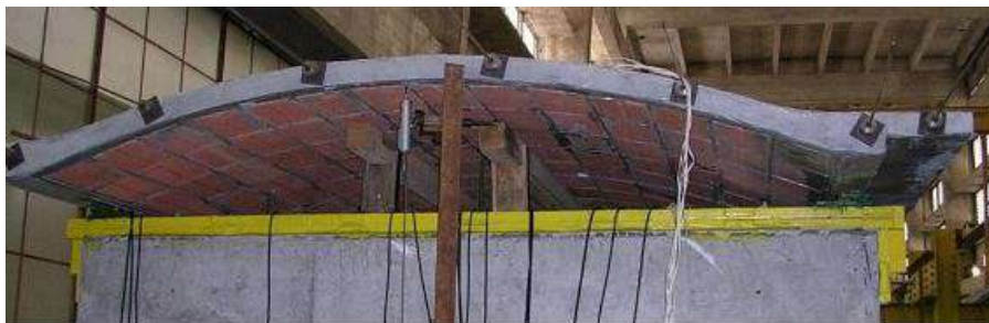
Figura 1.8 – Casca cilíndrica mista alvenaria cerâmica – argamassa, protendida e ensaiada no LabEST [46].
