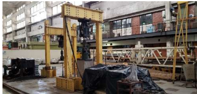
Figura 5.29 – Pórticos para o ensaio de ruptura ao esforço cortante.
