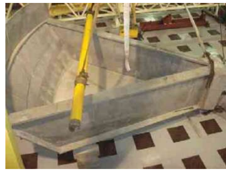
Figura 1.12 – Análise experimental de um setor do flutuador de paredes finas: (a) Projeto desenvolvido pela Controllato, (b) montagem das formas e (c) início dos ensaios mecânicos [51].
