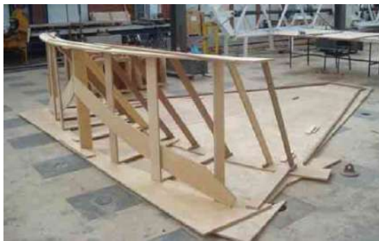
Figura 1.12 – Análise experimental de um setor do flutuador de paredes finas: (a) Projeto desenvolvido pela Controllato, (b) montagem das formas e (c) início dos ensaios mecânicos [51].
