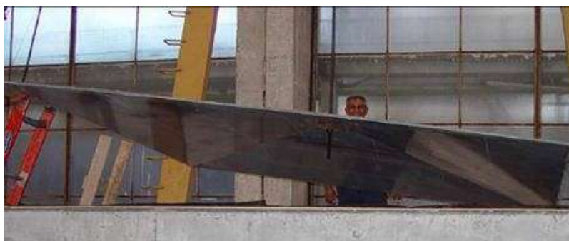
Figura 1.10 – Posicionamento sobre apoios da casca tronco-piramidal de 10mm de espessura, fabricada com CUADRFA, e ensaiada a flexão no LABEST [47].
