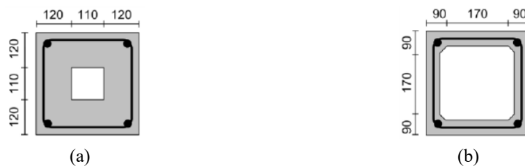
Figura 2.21 – Seção transversal de viga celular: (a) apoios, (b) trecho ao longo do vão livre [111].
