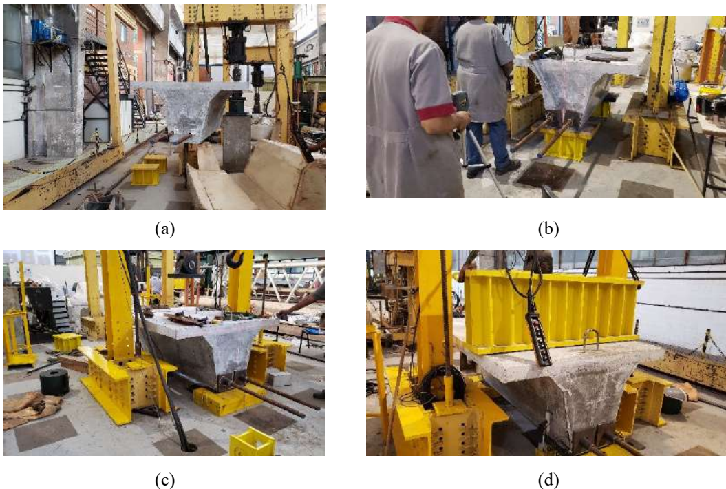
Figura 5.35 – Montagem do setup: (a) içamento e posicionamento, (b) verificação inicial das posições da longarina e apoios em relação ao pórtico e ao piso, (c) verificação do alinhamento horizontal da mesa superior, e (d) posicionamento da viga travessa.
