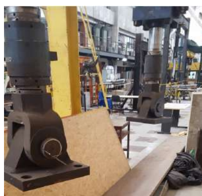
Figura A. 17 – Atuadores hidráulicos: destaque para as chapas de contato.
