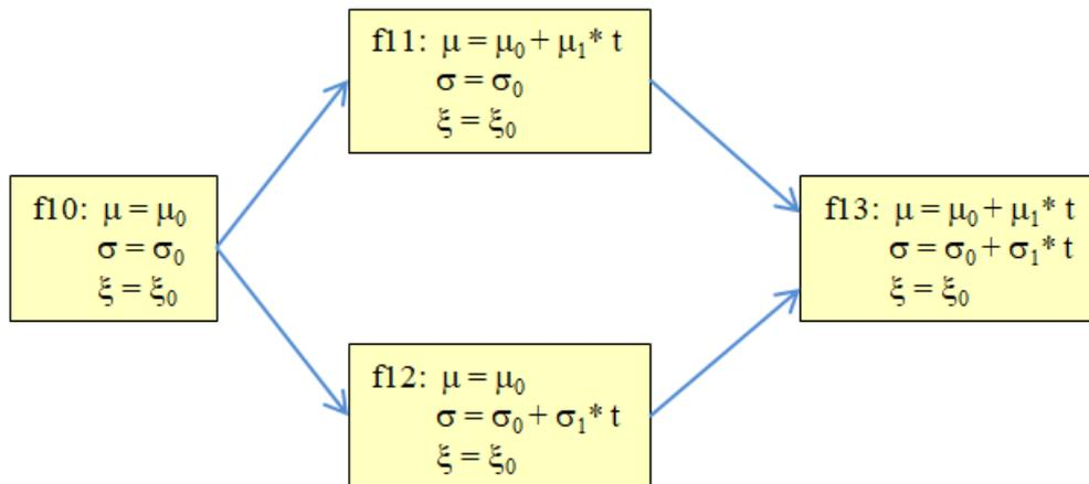
Figura 5.2 – Diagrama esquemático da sequência dos testes de estacionariedade considerando a evolução a partir da análise temporal.
