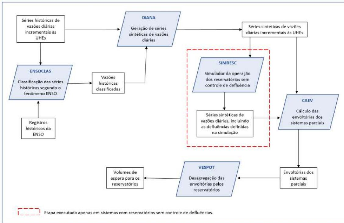
Figura 2.5 - Cadeia de modelos do Sistema para Estudos de Prevenção de Cheias (SPEC).
