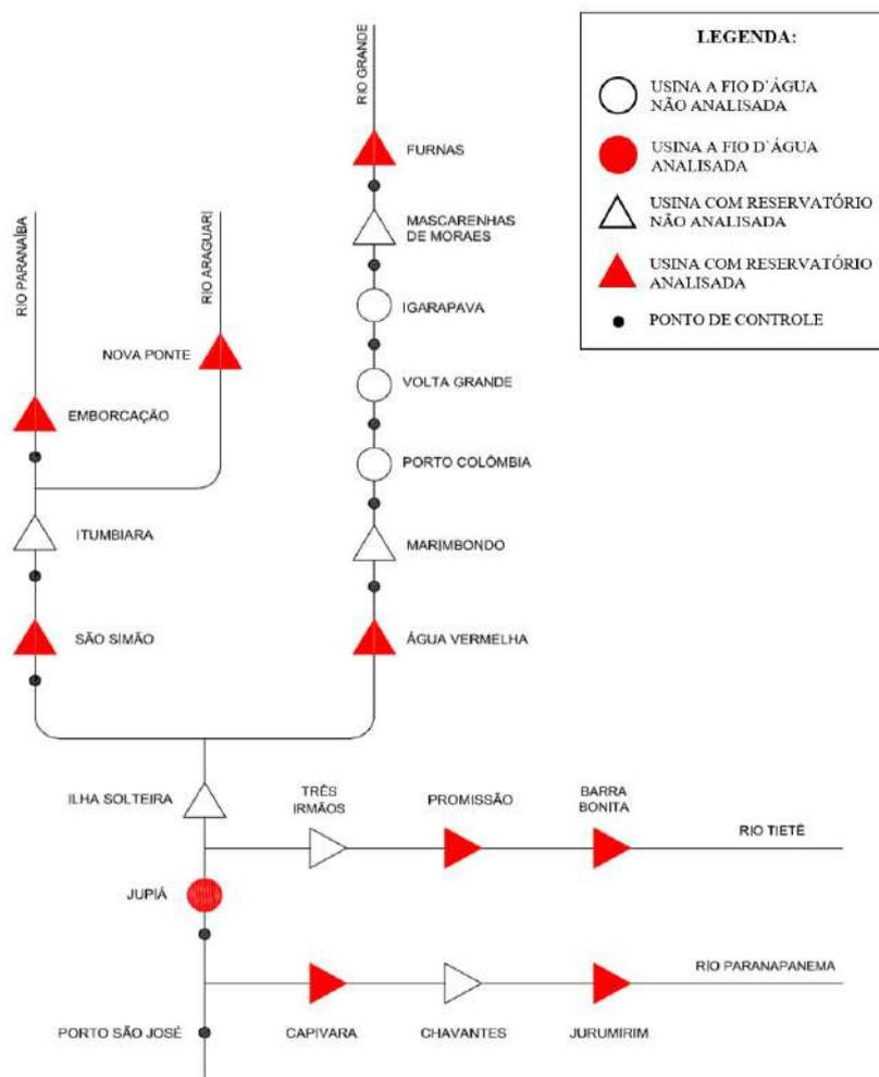
Figura 6.2 - Topologia do sistema de controle de cheias da bacia do rio Paraná até o posto fluviométrico de Porto São José com destaque para as UHEs selecionadas.
