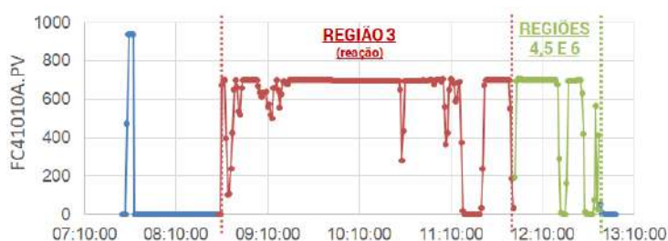
Figura 3.3: Figura esquemática mostrando a vazão da válvula de controle ao longo de uma batelada .
