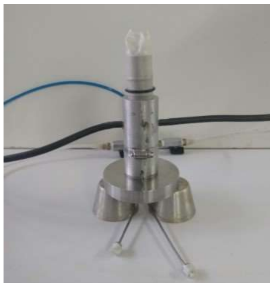
Figura 3.21: Corpo de prova já reconstituído e pronto para ser colocado no equipamento de CR
