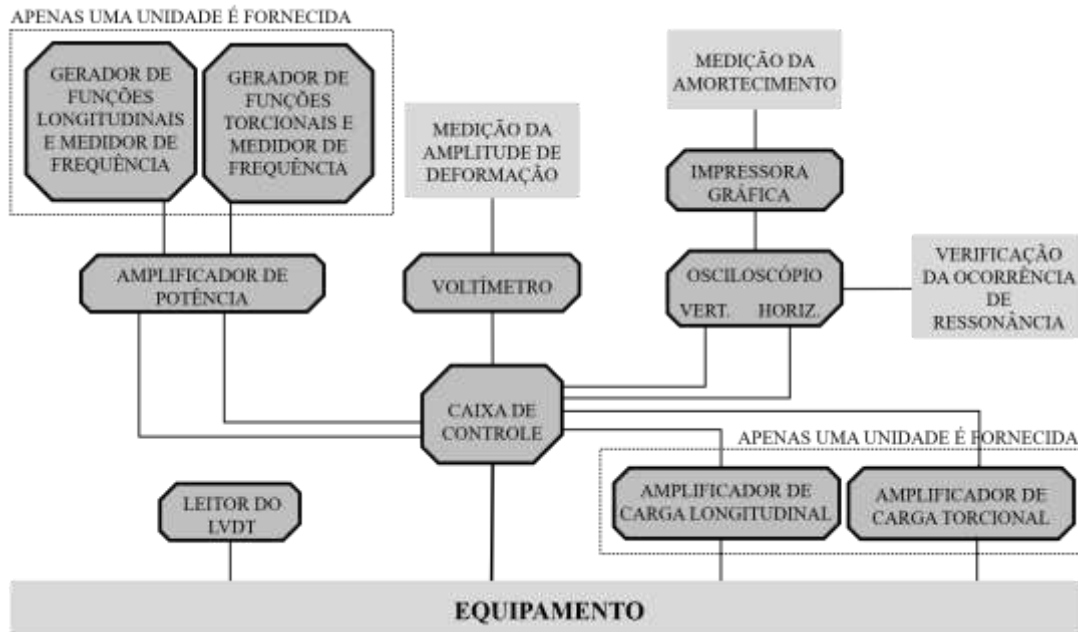
Figura 3.16: Esquema de funcionamento dos equipamentos para o ensaio de Coluna Ressonante
