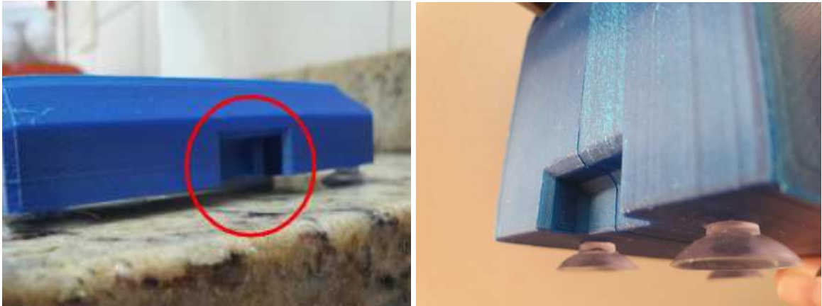
Figura 62: (a) e (b) Partes dos modelos onde a alavanca encaixa para descolamento das ventosas.
