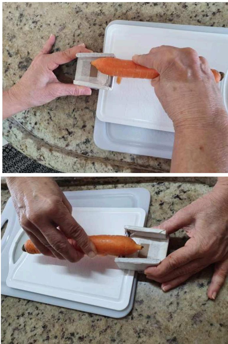
Figura 50, e 51: Teste prático do uso do modelo do descascador realizados por uma pessoa sem dificuldade motora.
