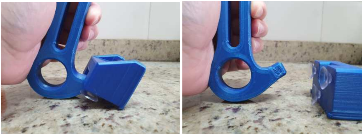
Figura 56: (e) e (f) Funcionamento da alavanca descolando das ventosas.
