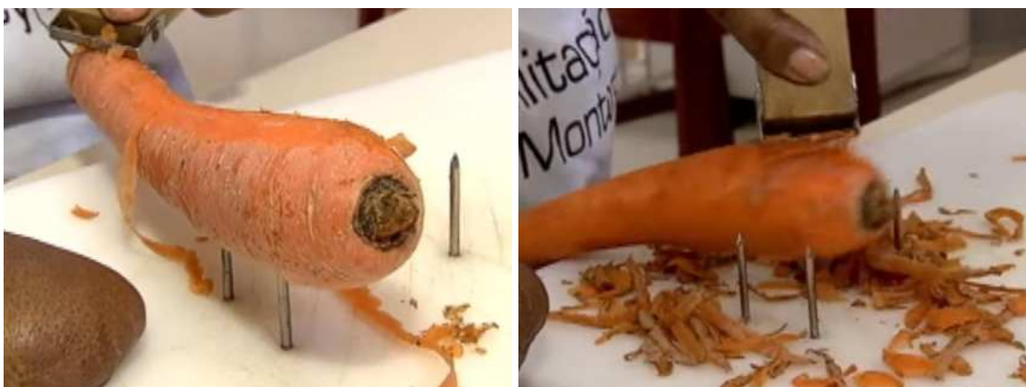
Figura 36: (a) e (b) imagens retiradas do vídeo que mostram o produto mal fixado e posteriormente escapando dos espinhos da tábua de corte.
