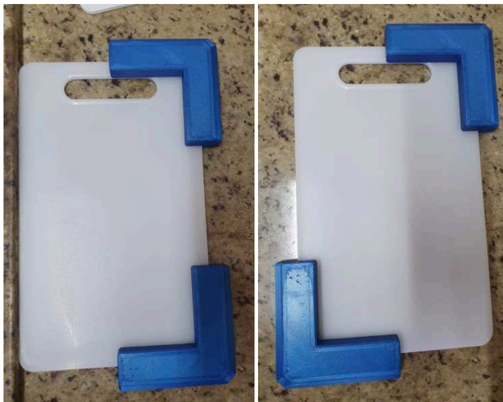
Figura 69: (a) e (b) Disposição das cantoneiras para segurar a tábua de corte.
