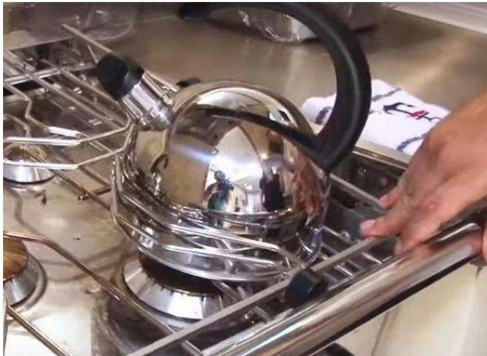
Figura:39: Fogão para barco a vela, com dispositivo para segurar panelas, as hastes de alumínio acoplados ao fogão envolvem a leiteira para que ela não fique indo de um lado para o outro.
