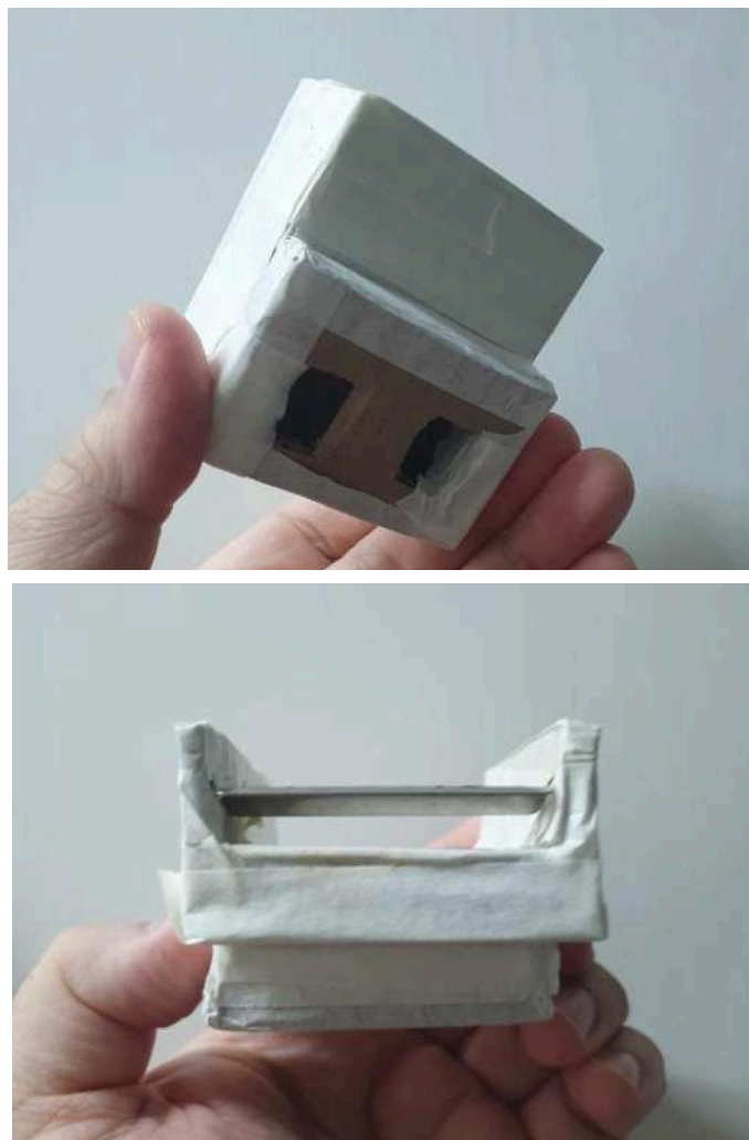
Figura 48, e 49: Modelos físicos feitos de papel pluma e fita adesiva.
