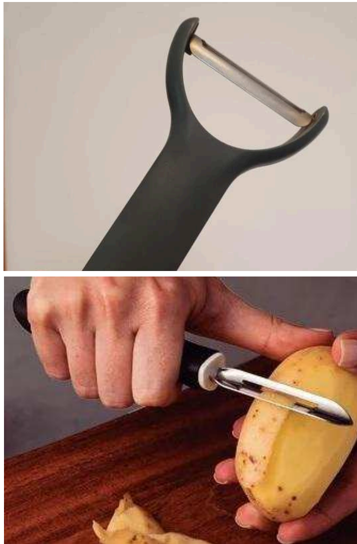
Figura 9: (a) e (b) Descascadores de legumes, um com a lâmina deitada e outro com a lâmina como se fosse de uma faca
