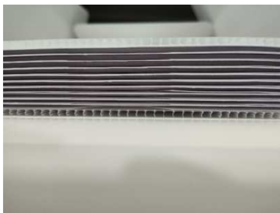
Figura 12 – Poliondas nas extremidades do conjunto de negativos de vidro
