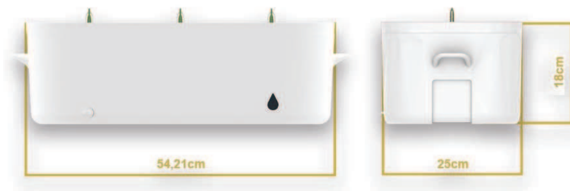
Figura 108: Dimensão total dos tanques.
