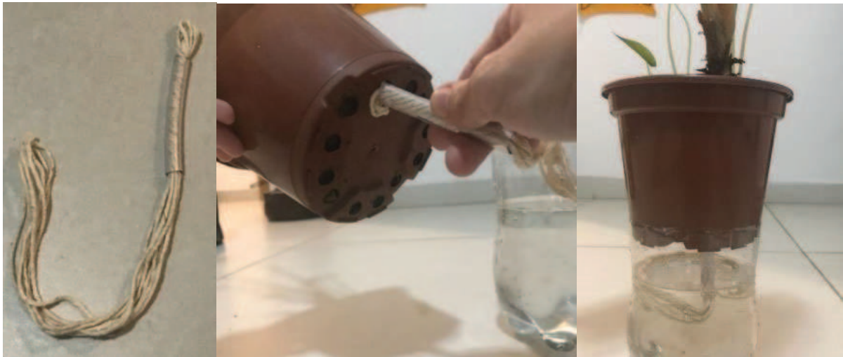
Figura 74: Testes de aplicador capilar.
