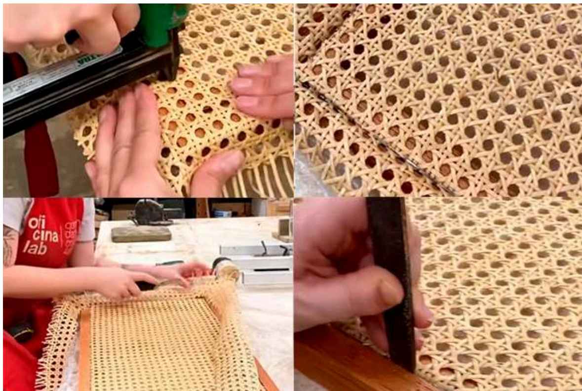
Figura 93: Passo a passo para aplicação de palha indiana na estrutura. Fonte: Juca.mobília . Acesso em: 12/03/2024.
