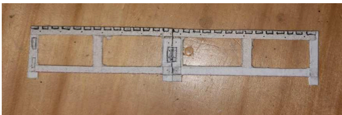
Figura 42: Mockup de lateral do quinto modelo, com estrutura abaixo para melhorar resistência e estabilidade. Fonte: Autora.
