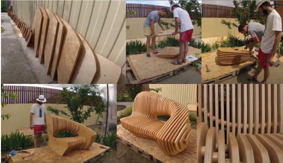
Figura 145 - Processo de montagem do banco paramétrico Fonte: Vmumok Design
