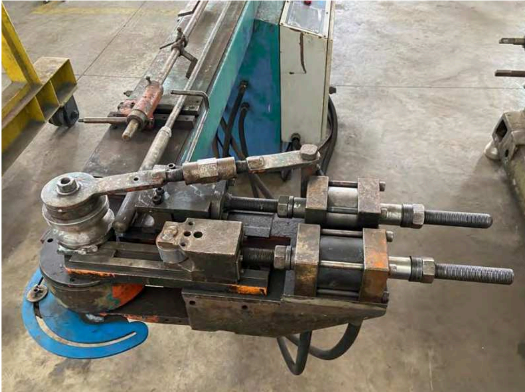
Figura 146 - Processo curvamento hidráulico de tubos
