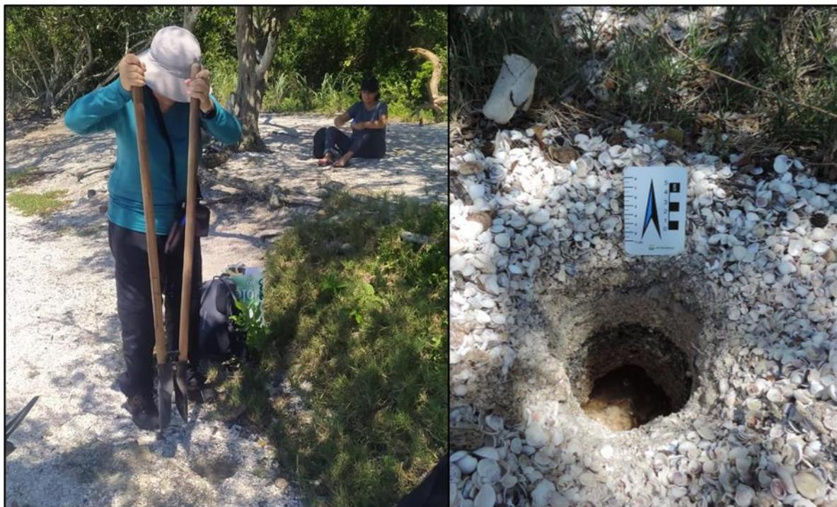
Figura 18 - Pesquisa feita com cavadeira no Ponto 2. É possível ver os níveis escuros com acumulação de minerais pesados como, magnetita.
