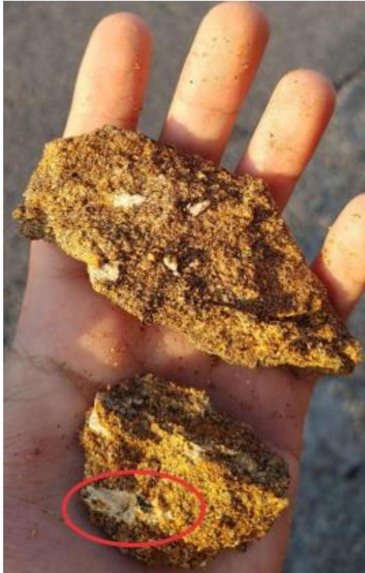
Figura 38 – Amostra retirada do afloramento SAPAL-I-18.7, circulado em vermelho se encontra uma cianita preservada, parcialmente substituída por sillimanita.
