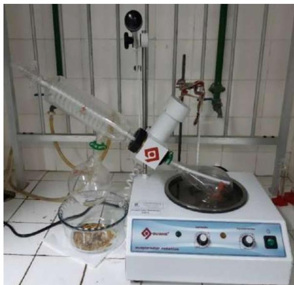
**Figura 17.** Fotografia do evaporador rotatório.
