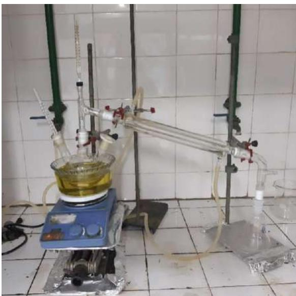
**Figura 16.** Fotografia da aparelhagem para destilação simples.
