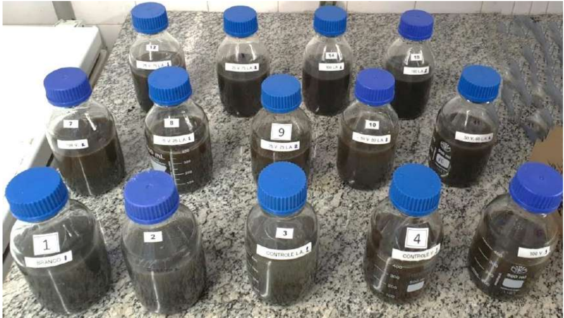
Figura 12: Frascos com inóculo + (vinhaça:lodo)(% v/v) avaliados no teste de potencial bioquímico de biometano.
