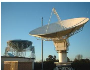
Figura 17: Radiotelescópio de 7 metros no Observatório de Jodrell Bank (Universidade de Manchester – Reino Unido)
