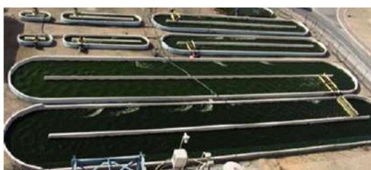
Figura 1 – Reator do tipo “ raceway ” (sistema aberto para cultivo de microalgas).
