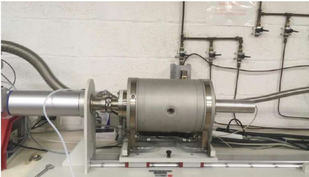
Figura 2.12 – Dilatômetro horizontal utilizado nas análises de dilatometria para estudo da evolução microestrutural.
