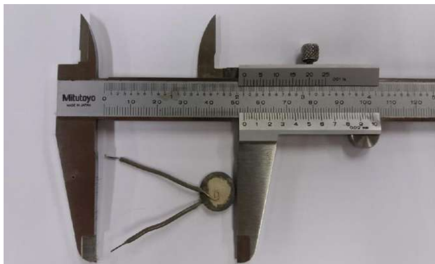
Figura 3.19 – Amostra após tratamento térmico com eletrodos de prata em ambos os lados e cabos elétricos.
