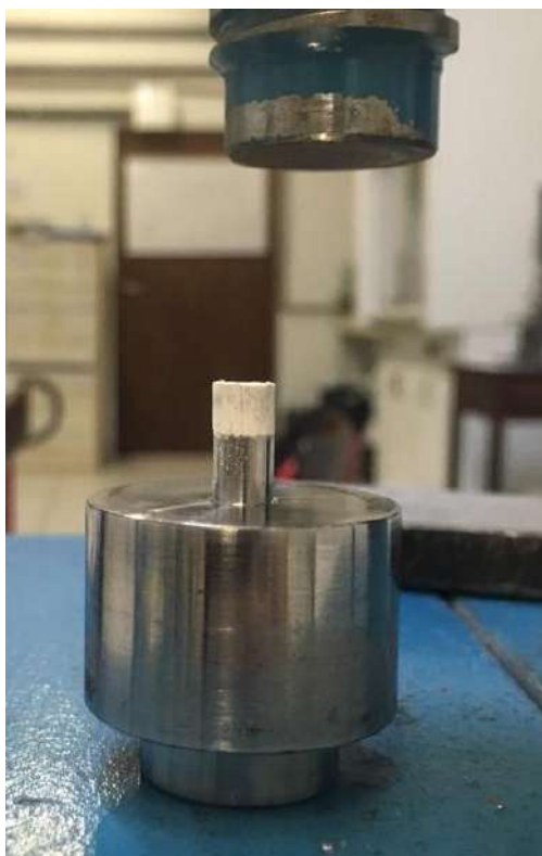
Figura 2.13 – Compressão uniaxial para a formação do corpo a verde.
