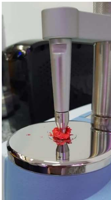
Figura 13 – Filme de tinta passando por análise em módulo ATR.
