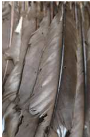
Figura 14: Detalhe evidenciando o ataque biológico.
