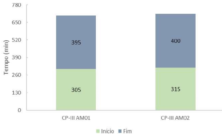
Figura 25 – Tempo de início de fim de pega das amostras de cimento CPIII 32 RS produzidas.
