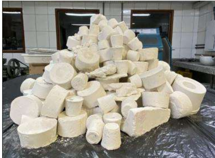
Figura 14 – Resíduo de gesso hidratado cedido pela UFRJ.
