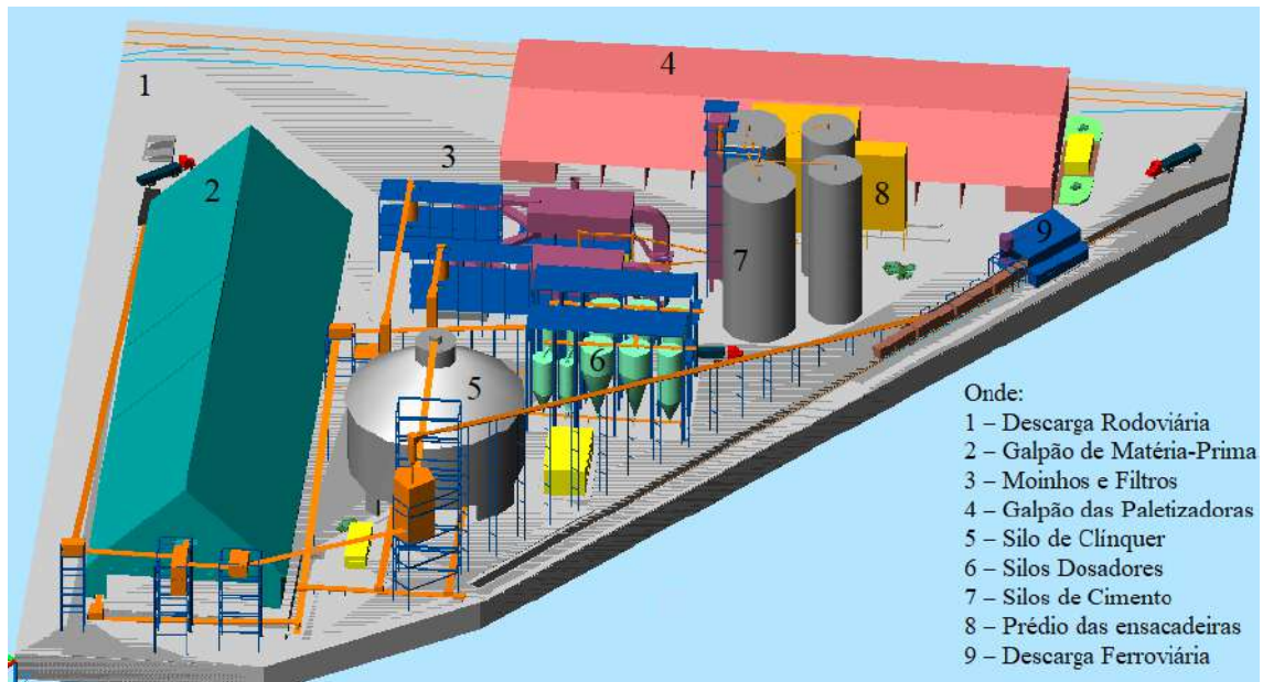
Figura 27 – Planta 3D: Processo produtivo do cimento.
