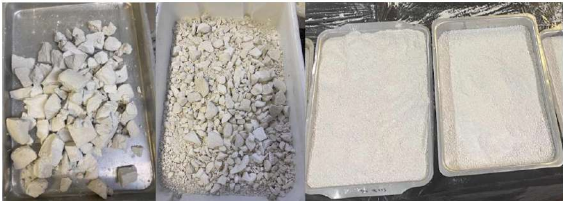
Figura 16 – Diminuição da granulometria ao longo de britagens consecutivas.
