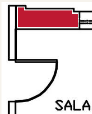
Retirar paredes originais (com espessura maior)
