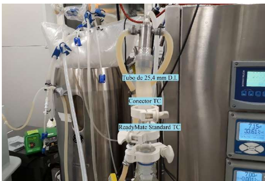
Figura 5-6. Proposta final para a linha de reciclo do underflow para o biorreator descartável, por meio de uma conexão com ReadyMate™ com diâmetro interno de 19,7 mm acoplado a uma mangueira de silicone com 25,4 mm de diâmetro. Nesse experimento, o conteúdo do underflow foi coletado em uma garrafa Schott de 10 L.
