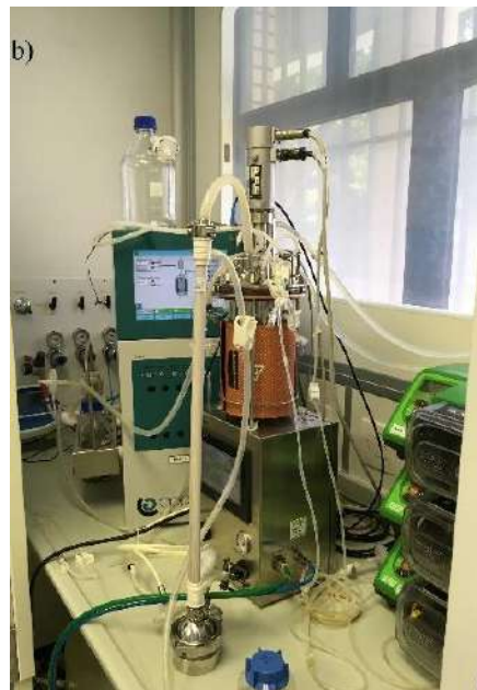
Figura 3-6. A) Representação esquemática dos ciclos de pressão e de exaustão com ar comprimido e vácuo, que conferem o movimento alternante ao ATF. HFM – hollow fiber membrane (adaptado de Repligen 2015). B) Sistema ATF2 acoplado a um biorreator Applikon com vaso de 3 L, usado no presente trabalho no LECC/COPPE/UFRJ.
