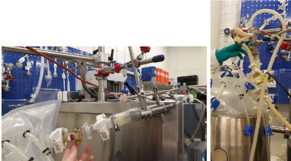
Figura 5-9. Proposta para a conexão entre o underflow e o biorreator utilizando conectores ReadyMate™ (esq.). HC2015 instalado; a posição vertical foi obtida dobrando-se cuidadosamente a bolsa (dir.).
