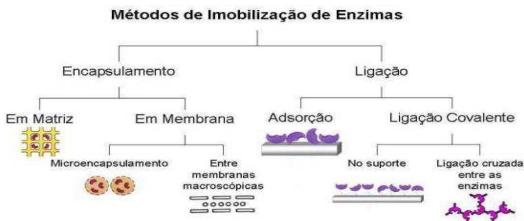
Figura 3 – Métodos de imobilização enzimática. Fonte: Brígida, 2010.
