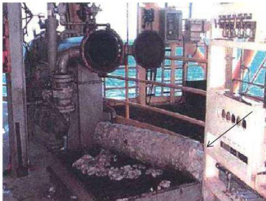
Figura 3. Hidrato formado em linha de produção (UNIVERSIDADE PETROBRAS, 2007).
