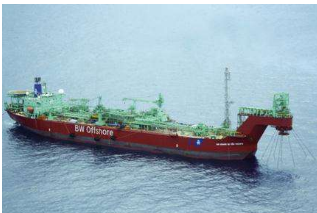
Figura 20. FPSO Cidade de São Vicente com um sistema de Turret (BW OFFSHORE, 2013).
