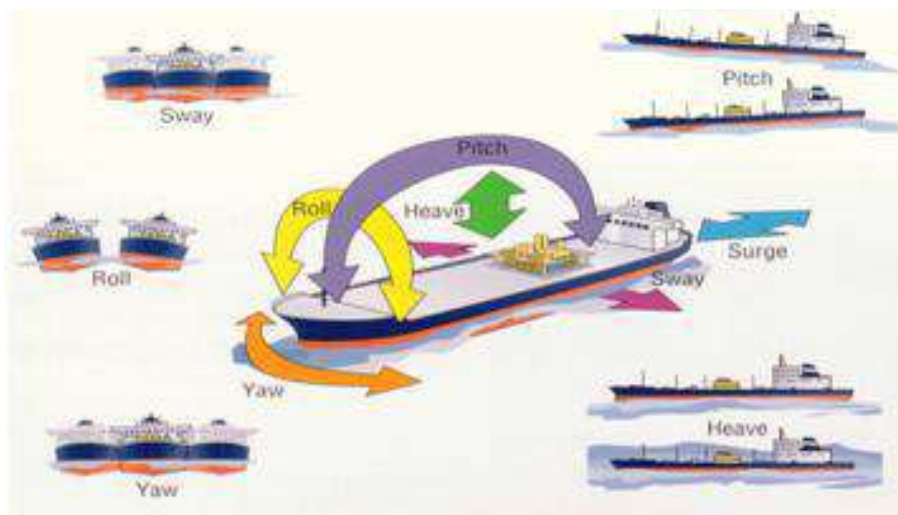
Figura 19. Movimentos da plataforma devido à incidência de ondas do mar(AMBROSIO, 2007).
