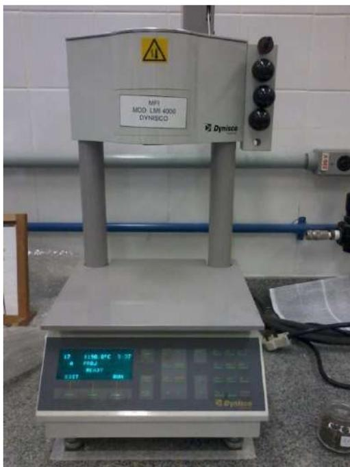
**Figura IV.8: Equipamento de fluidez – Laboratório de Tecnologia IMA/UFRJ**
