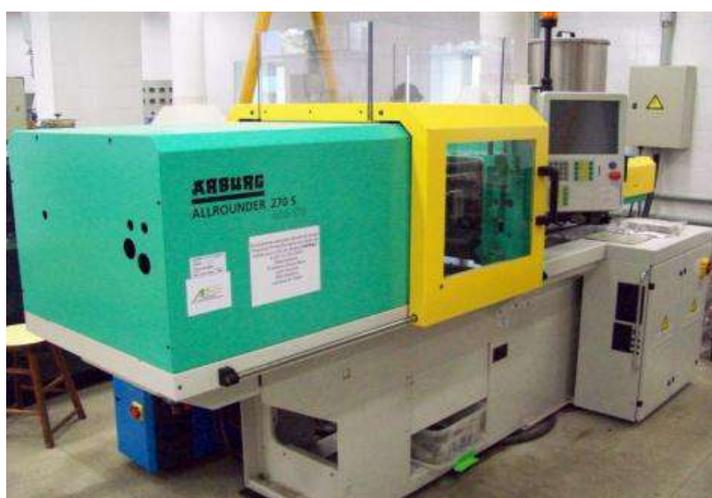
Figura IV.5: Injetora Arburg – Laboratório de Tecnologia IMA/UFRJ
