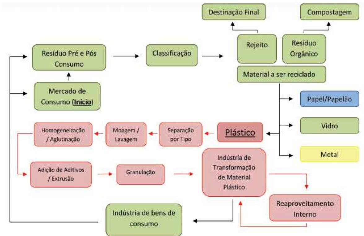
Figura II.8: Fluxograma da reciclagem mecânica (ABIPLAST, 2011)
