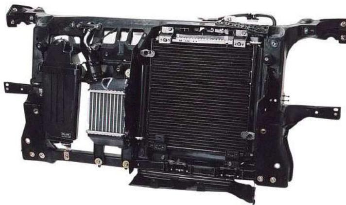
Figura II.6: Módulo de Polipropileno reforçado.
