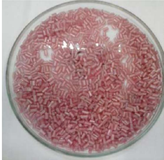
Figura IV.10: Pellets dos compósitos contendo PP reciclado.
