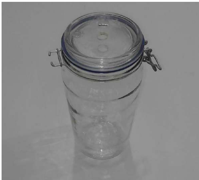
Figura 14: Recipiente de vidro utilizado como biorreator.
