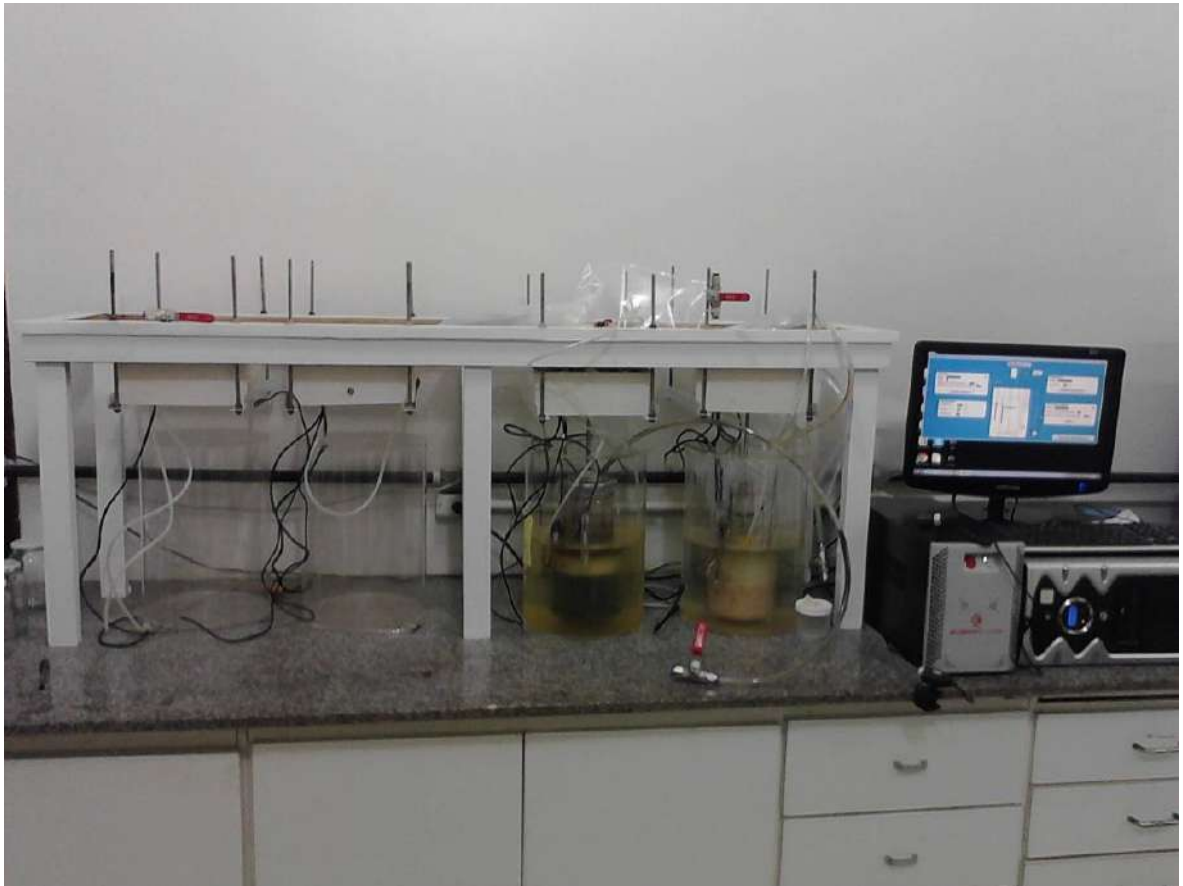
Figura 31: Quatro biodigestores em escala de bancada do tipo batelada com sistema de controle e automação.
