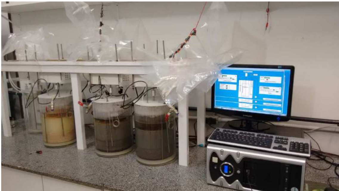
Figura 17: Biodigestores conectados às bolsas de Tedlar e ao computador
