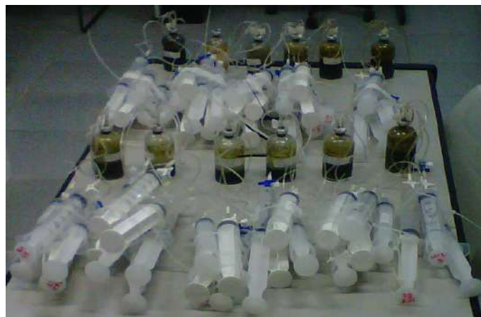
Figura 13: Frascos inoculados preenchidos, com inóculo, e acoplados
