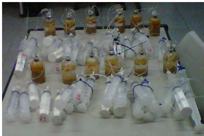
Figura 12: Frascos preenchidos, sem inóculo, e acoplados
