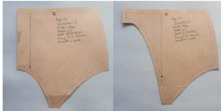
Figura 30 - Molde de corte frente e costas
