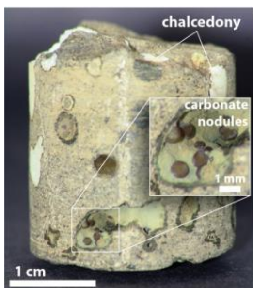
Figura 4.93: Amostra do poço Wallula Gap dois anos após a injeção de CO 2 . O basalto apresenta mineral Ankerita como resultado da mineralização de CO 2 . Fonte: Schaeff & McGrail (2016).
